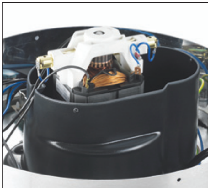
Рис. 8-4: Смена контактных щеток
