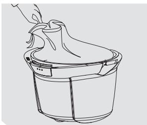
27. Вытащите пластиковый пакет. Установите новый пластиковый пакет, предварительно вставив туда фиксатор. Проверьте состояние картриджного фильтра. При необходимости очистите, промойте или замените его.
